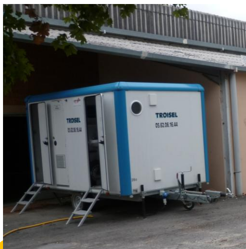
Sas de décontamination
